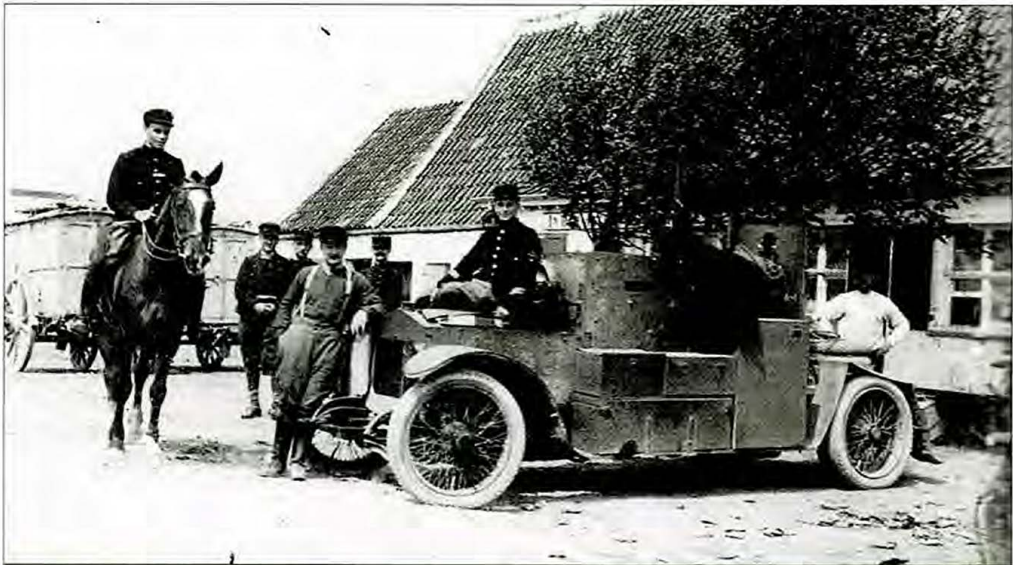
Deze Minerva automitrallouse, bezet met 4 mm dikke stalen platen rond de motor en rond de cabine, is uitgerust met een Hotchkiss mitralluse, die bediend wordt vanuit de cabine.
